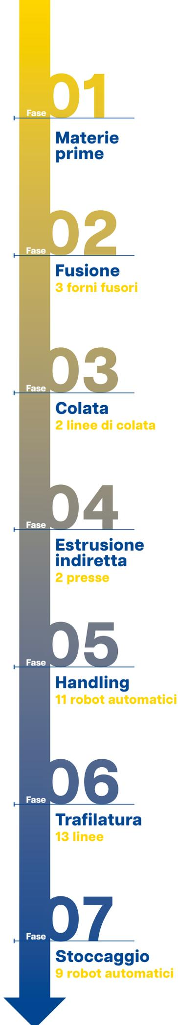
La prima fase del processo è proprio la **fusione del metallo**: il reparto fonderia si compone di due linee di colata continua per la produzione di billette in ottone.
